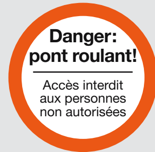
Fig. 1: lorsqu'une personne non autorisée pénètre dans la zone du pont roulant, il faut arrêter ce dernier et faire sortir cette personne de la zone.
