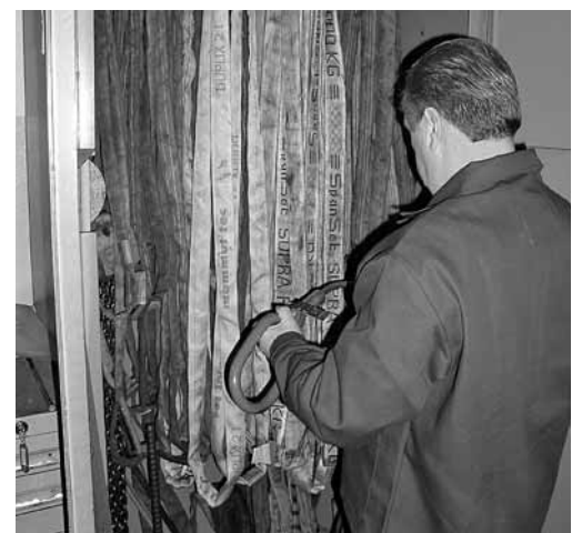
Figure 8: le bon état des élingues doit être vérifié par un spécialiste.
