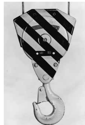
Figure 3: points d'entrée sécurisés de la poulie à câble.
