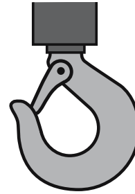
Figure 1: crochet de levage avec un linguet de sécurité.
