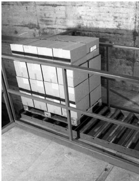
Figure 8: il est possible de transporter aussi des marchandises de grand gabarit sur des transporteurs à rouleaux sur lesquels il n'est pas pratique de s'engager. A l'extrémité, il faut installer une butée pour empêcher la palette de tomber dans le vide.
