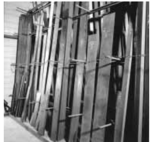
Figure 2: entreposage vertical des barres dans des râteliers avec un dispositif antiglisement et antirenversement.
