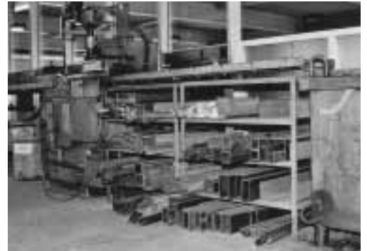
Figure 6: stockage des chutes de barres et de profilés à proximité immédiate de la scie.
