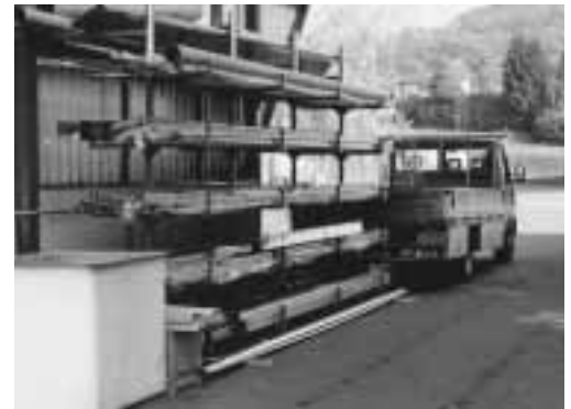
Figure 1: zone de réception des marchandises équipée d'une étagère pour l'entreposage provisoire des barres.
