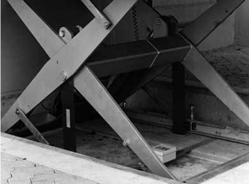
Fig. 9: avec les béquilles dépliées, le personnel d'entretien est protégé contre un abaissement involontaire de la plate-forme.
