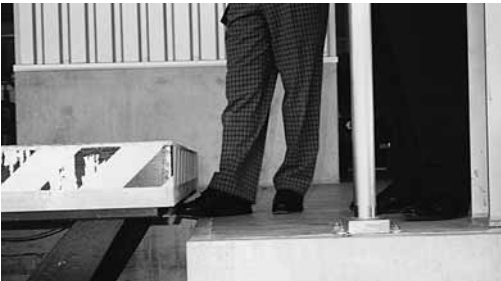
Fig. 8: les listeaux de contact évitent qu'une personne inattentive se trouvant à proximité immédiate de la plate-forme ne se coince le pied.
